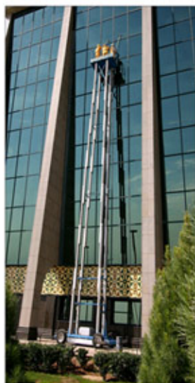
بالابرهای هیدرولیک سری EHL (چهار ریل) با ارتفاع کاربردی: ۱۲-۱۳-۱۴ و ۱۸ متری - برای کار کردن همزمان سه نفر جابه جایی راحت مجهز به چرخ خودروبی، دارای سیستم الکتروهیدرولیک، برق تکفاز شهری و یا برقی و باطری
