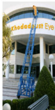
نردبان های کشویی چرخدار سری DML - ارتفاع کاربردی: ۱۶ - ۱۸ و ۱۸ متری با سیستم دستی مناسب نقاط مرتفع - مجهز به سیستم ضد سقوط
