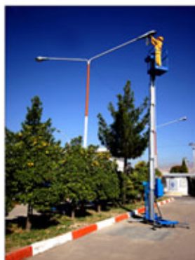
بالابر هیدرولیک سری EHS (نگ ریل) ارتفاع کاربردی: ۸-۹-۱۰ و ۱۱ متری سیستم الکتروهیدرولیک، برق تکفاز شهری و یا برقی و باطری قابل کنترل از داخل سکو و بیرون دستگیره دارا بودن چرخ خودروبی و چرخ کارگاهی ظرفیت بار ۱۳۰۰ کیلوگرم (نگ تفره)
