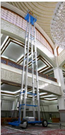
بالابرهای هیدرولیک سری EHL (چهار ریل) با ارتفاع کاربردی: ۱۲-۱۳-۱۴ و ۱۸ متری - برای کار کردن همزمان سه نفر جابه جایی راحت مجهز به چرخ خودروبی، دارای سیستم الکتروهیدرولیک، برق تکفاز شهری و یا برقی و باطری
